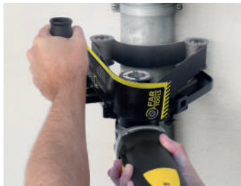
Carter pour aspiration des poussières Housing for dust extraction
