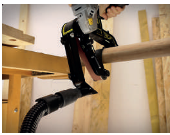
Carter pour aspiration des poussières Housing for dust extraction
