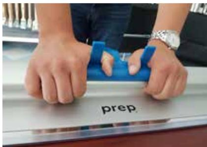
Poser le Flexo'prep à plat. Positionner l'adaptateur de perche à l'arrière de la poignée. Placer les 2 mains sur l'adaptateur en maintenant les 2 pattes de serrage redressées.
