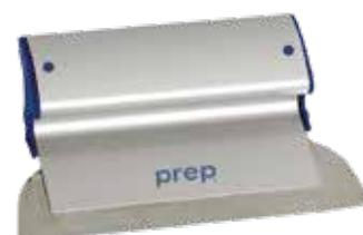
**Mettre la lame dans le couteau** : reclipser le cache sur le côté du couteau. Retourner la lame sur la face où les 3 encoches sont visibles. Glisser la lame à l'arrière du couteau jusqu'à entendre un clic.
