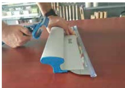
Pour retirer l'adaptateur : prendre appui d'une main sur la poignée et baisser lentement l'une des deux pattes avec l'autre main. L'adaptateur se retirera automatiquement.
