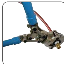
3 - Placer la pince à sertir au niveau de la bague et actionner les leviers.
