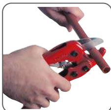
1 - Couper le tube proprement.
