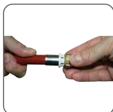
2 - Placer le raccord sur le tube en s'assurant qu'il soit bien positionné en butée (fenêtre de contrôle).
