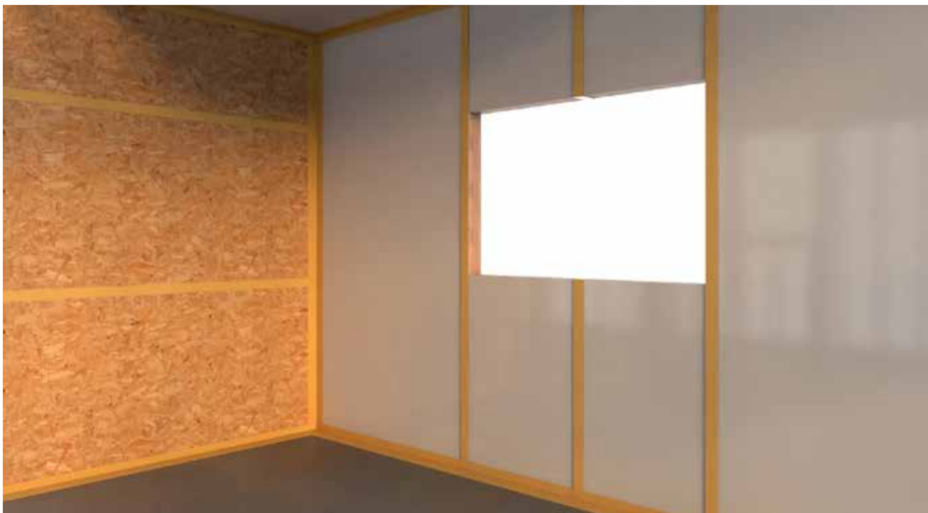
Jonctions de pare-vapeur et de panneaux OSB
