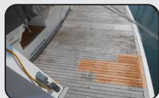
Décaper le bois Stripping the wood
