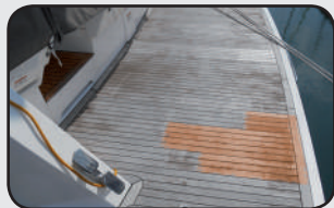
Décaper le bois Stripping the wood
